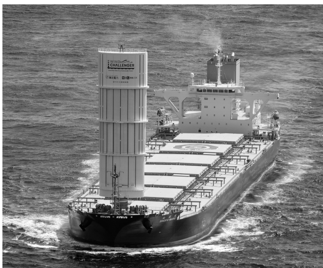
風から推進力を得て温室効果ガスを削減する硬翼帆搭載船
